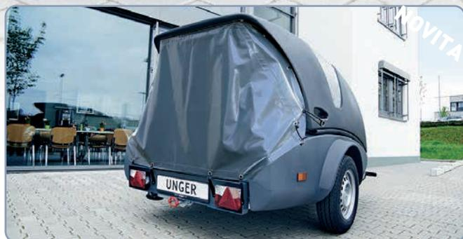
Copertura opzionale per proteggere gli avvolgi tubo. Robusto telone che può essere montato in modo semplice al telaio.
