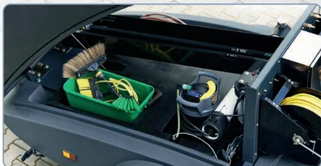
Con compartimento para hasta 6 mangos con conducción de agua de hasta 1,91 m de longitud. Compartimentos laterales para alojar cepillos y otros accesorios.
