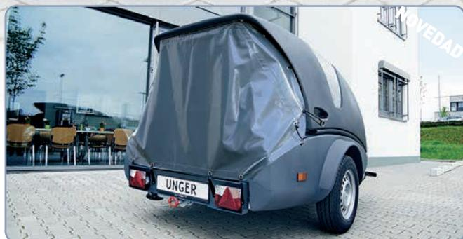
Cubierta opcional. Para proteger los carretes de mangueras. Lona altamente resistente que puede ser fijada fácilmente a través de puntos de fijación al remolque.
