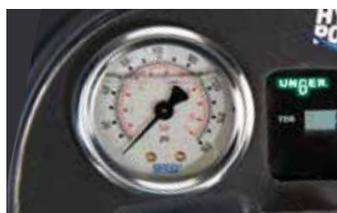
El **manómetro** indica la presión de agua detrás de la bomba cuando la bomba está en funcionamiento. Asegúrese de que la presión de agua es de al menos 1 bar. Lo ideal son 4 bar, el máximo admisible son 6 bar.
