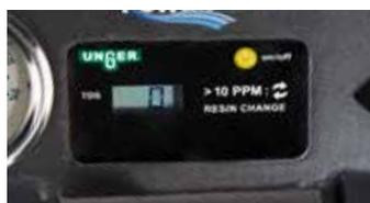
El **medidor de TDS** muestra la calidad del agua en la salida para el modo TAP BOOST y PURE.
