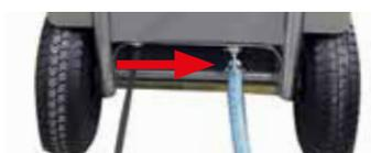
En la parte inferior trasera está la salida de agua para el concentrado. Derivar el concentrado a un desagüe con la manguera de concentrado suministrada.
